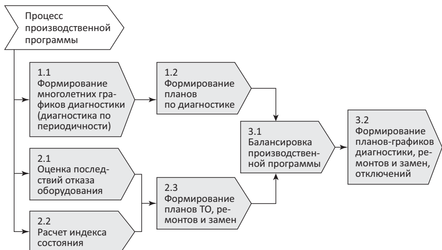
Рис. 14. Схема процесса «Планирование производственной программы»
