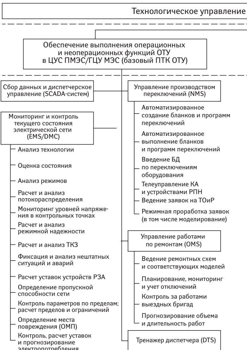
Рис. 4. Функциональная структура АСТУ
