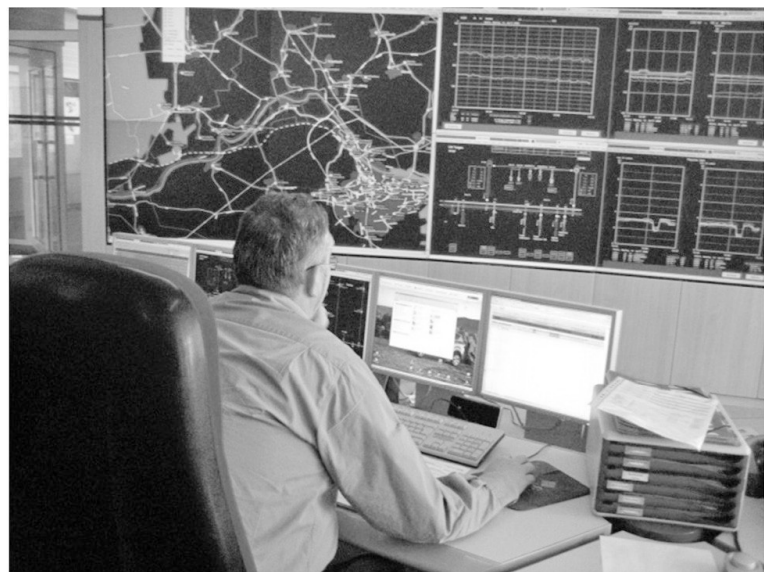
Рис. 5. Рабочее место диспетчера со средствами отображения системы SCADA (схемы сети и объектов, параметры режима, геоинформационная система и пр.)
