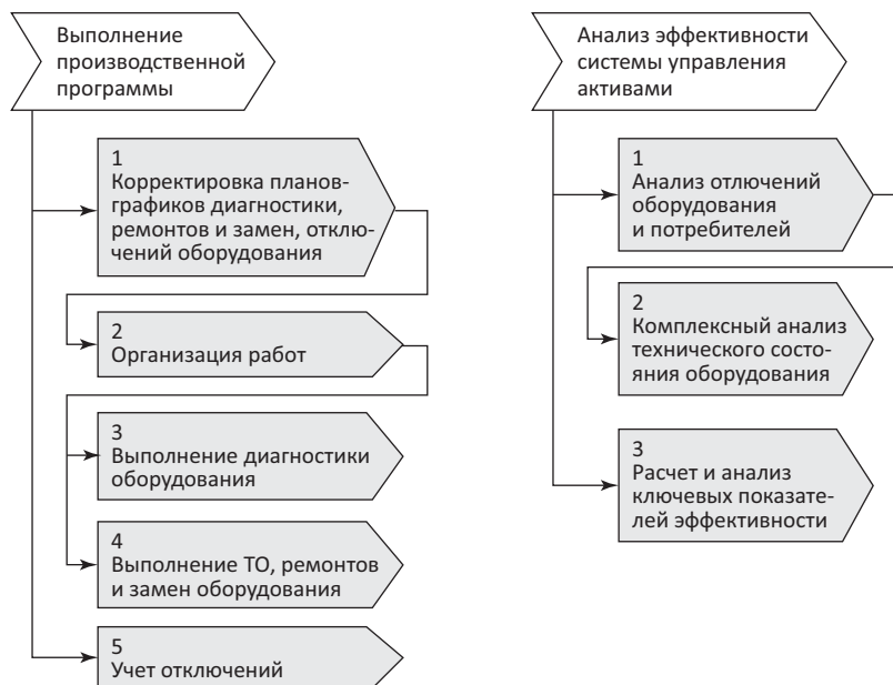
Рис. 15. Схема процесса «Выполнение производственной программы» (схема процесса верхнего уровня)
