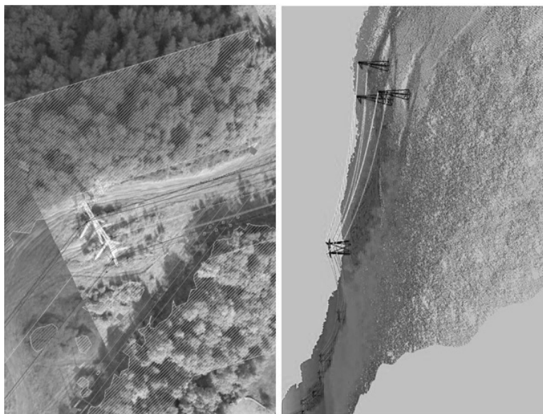
Рис. 9. Формы представления результатов аэросканирования ВЛ (двух- и трехмерные модели ВЛ, трассы с учетом окружающих объектов (поросль, пересечение двух ВЛ))
